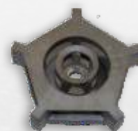
Schleuderrad mit 5 Schaufeln
